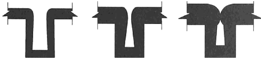
图 5-93 非保角覆盖 (non-conformal) 薄膜在接触孔或介层洞顶端引起突变,导致锁孔的产生
