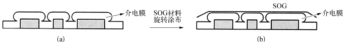
图 5-132 SOG 工艺示意图 (a) 填隙; (b) 平坦化
