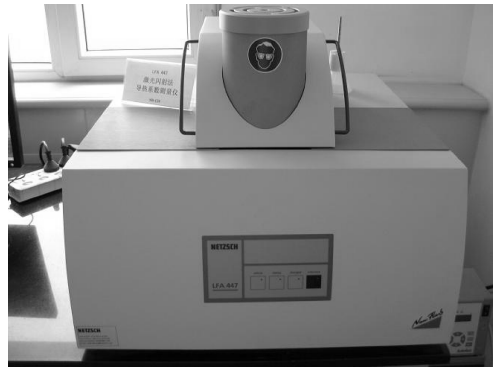
图 5-67 德国 NETZSCH 的 LFA447 激光闪射法导热系数测量仪
