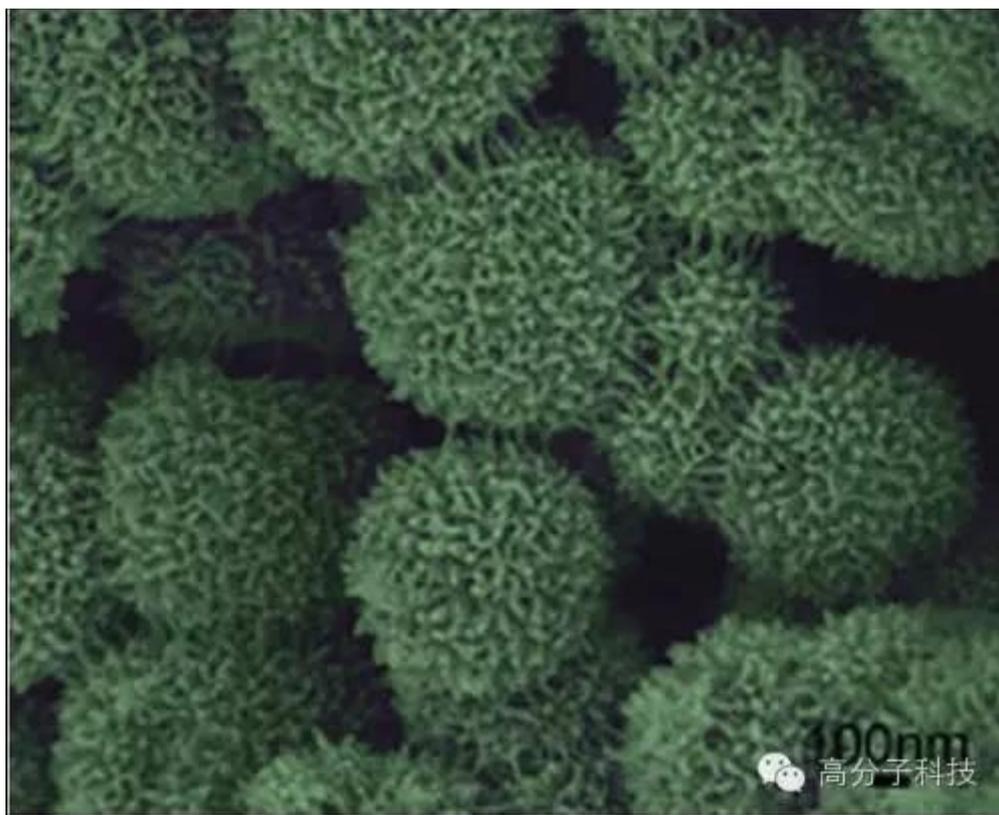
近期，微纳尺度的导电高分子空心球十分引人注目。通常，空心球往往通过球形粒子作为模板，例如二氧化硅胶体，PS珠，无机粒子等，随后通过煅烧、溶剂刻蚀等方法移除球心。由于总要移除球心物，因此再现性较差，并且在移除后难以保持原本的有序结构。
