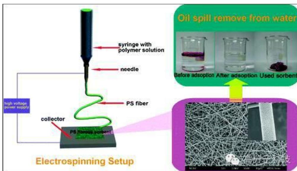
通过静电纺丝法制备一种低成本的高油吸附性的PS薄膜。不同的纤维直径和多孔纤维表面拓扑结构在油吸附性能和油水分离中起到重要作用。作者分别用柴油、硅油、花生油、机油对这种PS薄膜的吸油性能进行了测试，结果表明吸油性能高于普通的没有多孔结构的纤维吸附剂。即使是很薄的多孔PS薄膜吸附剂同样具有出色的油水分离能力。
