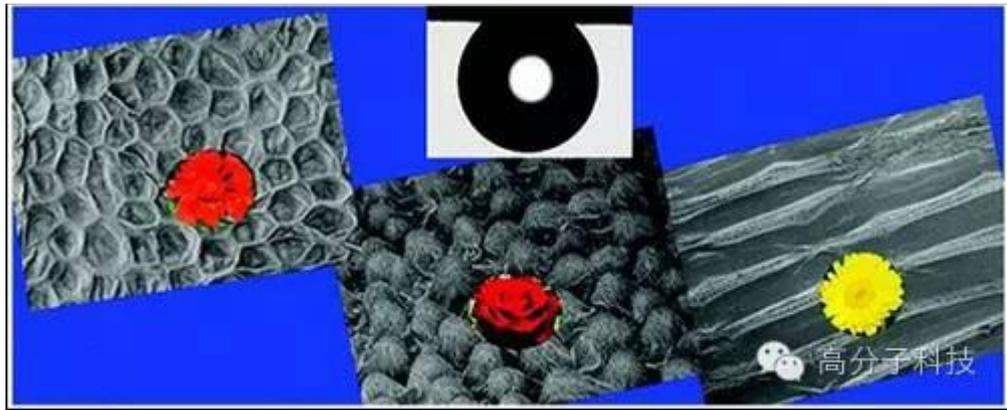
红玫瑰花瓣表面具有层状的微乳突和纳米褶皱，这些微纳结构为超疏水性提供了足够的粗糙度，同时也产生了对水的高粘附力。花瓣上的水滴呈现出球形，但将花瓣颠倒后却不易滚落。作者把这种现象称为“花瓣”效应，可与著名的“莲花”效应类比。作者通过对花瓣表面的模仿，使人工生产的仿生聚合物薄膜表面也具有了清晰的纳米压花结构。
