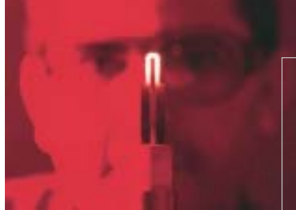
非大自然所能完成的杰作：使用纳米烟灰加工的陶瓷，用于抗腐蚀、辉光点火系统，如煤气暖炉。陶瓷具有可调节传导性，再也无需变压器。
