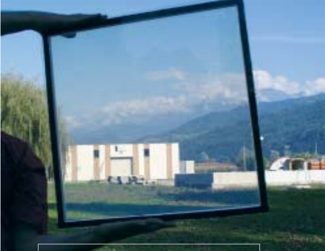
在双层玻璃中填充气凝胶有助于减少热损失。
