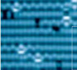
硅片上的单个有机分子。德国波鸿鲁尔大学 (Ruhr University of Bochum) 扫描隧道显微镜图像。
