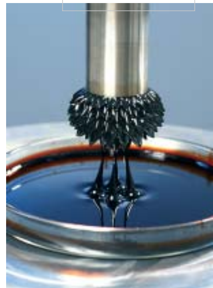
石油中的磁石纳米粒子：可控制流体，使其按磁性改变形状。
