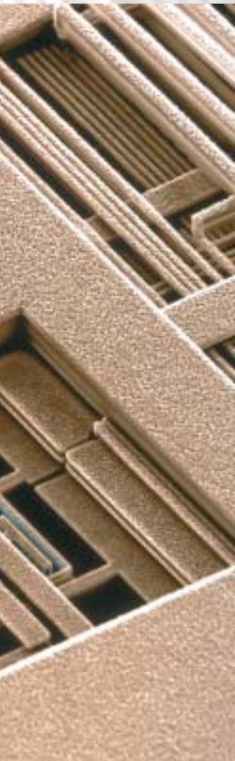
如同缩微城市般复杂—借助扫描电子显微镜观察到的芯片蚀刻铜电路 (IBM)。现代芯片有多达九级的电路。
