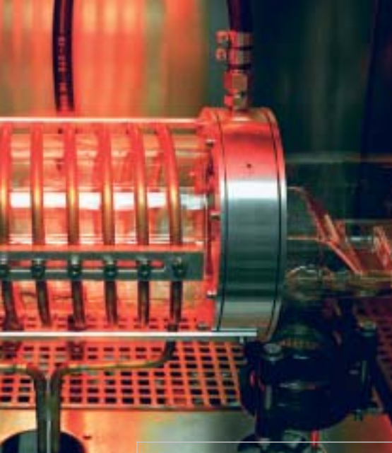
Aixtron 反应器，用于研究（左）及精密生产连接半导体薄层（右）。
