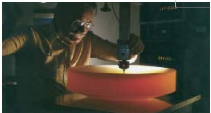
平版印刷罩的微晶玻璃, 是在纳米尺寸下仍可保持稳定的特殊陶瓷。
